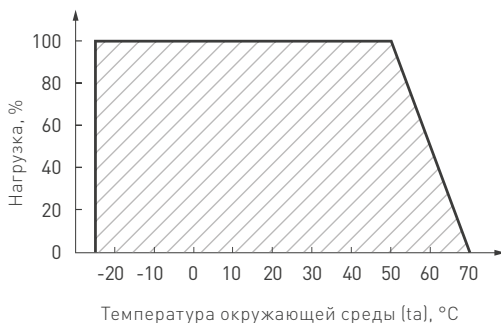
Рисунок 7. Максимальная допустимая нагрузка, % от мощности источника.
