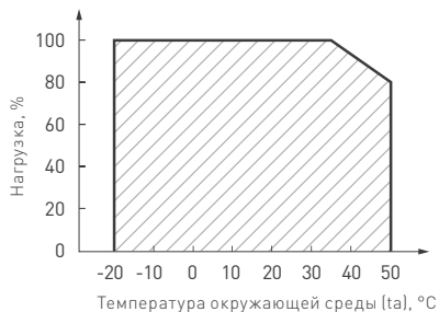
Рис. 2. Максимальная допустимая нагрузка, % от мощности источника.
