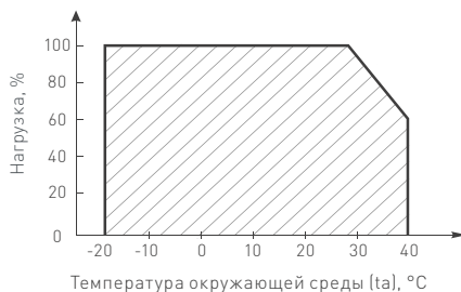
Рис. 2. Максимальная допустимая нагрузка, % от мощности источника.
