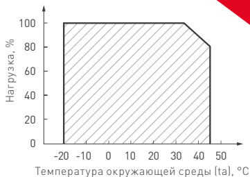
Рис. 3. Максимальная допустимая нагрузка, % от мощности источника.
